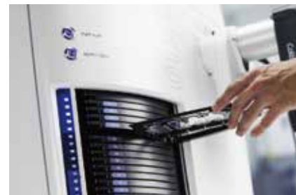
Axio Scan.Z1 全自动数字玻片扫描系统不同规格样品夹及“托盘式”样品架设计
