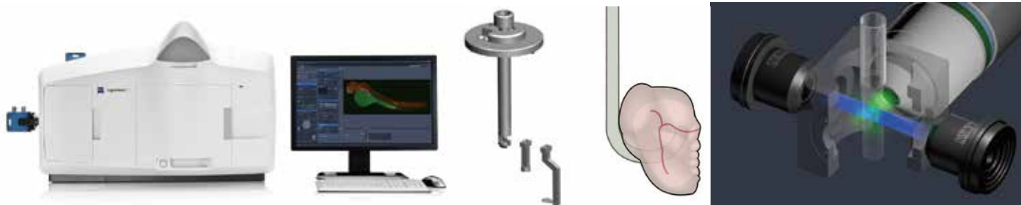
Lightsheet Z.1 样品夹适配器及光路示意图
