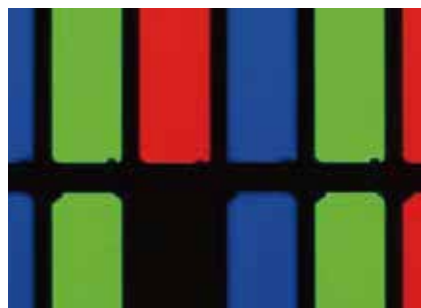
暗 Stuck Pixels 点：红色分像素点在不亮时在亮背景上显现的暗点
