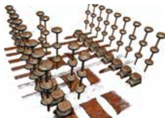
含 4 层晶片堆叠的 10 mm x 7 mm x 1 mm 封装内的 DRAM 封装互连。焊料挤压能轻松实现三维可视化, 0.8 μm/ 体素
