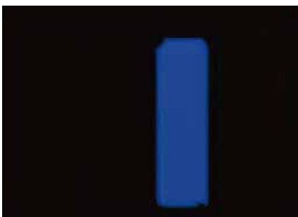
亮 Stuck Pixels 点：蓝色分像素点常亮时在暗背景上显现的常亮点
