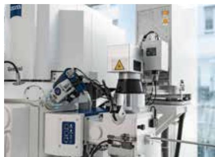
拥有独立仓室的飞秒激光加工系统在带来强烈蚀蚀能的同时可以避免污染主仓室。
