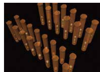
硅穿孔连线技术(TSV)— Xradia Ultra
